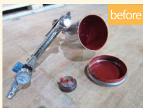
使用後のスプレーガンを約50°Cの液温で3~5分洗浄
