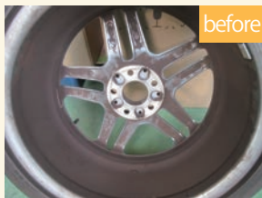
ホイールに焼き付いたカーボンを約50°Cの液温で3~5分洗浄
