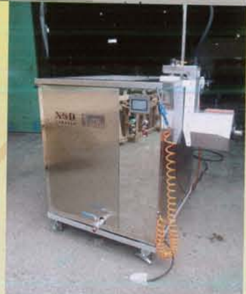
熱・洗剤・超音波の3つの力でホイールの汚れを一掃する超音波ホイール洗浄機「ソニックユース」
